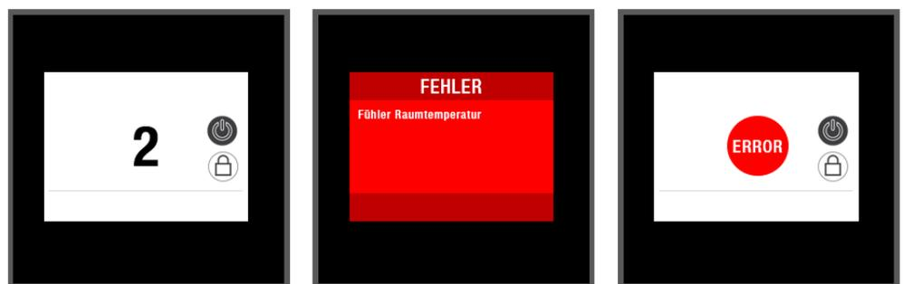
Hauptbildschirm mit aktivierter Tastensperre      Display, wenn ein Fehler vorliegt bei deaktivierter Tastensperre      Display, wenn ein Fehler vorliegt bei aktivierter Tastensperre
